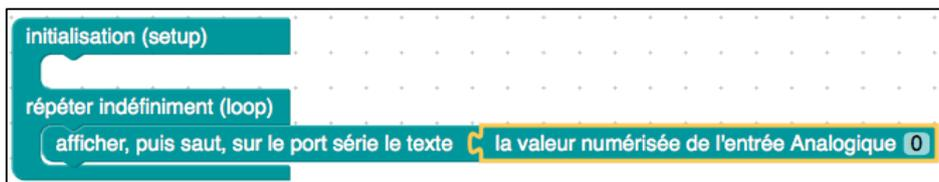
Figure 22 : Bloc Blockly@rduino pour lire la valeur d'un capteur infrarouge TCRT 5000 analogique sur le moniteur série
