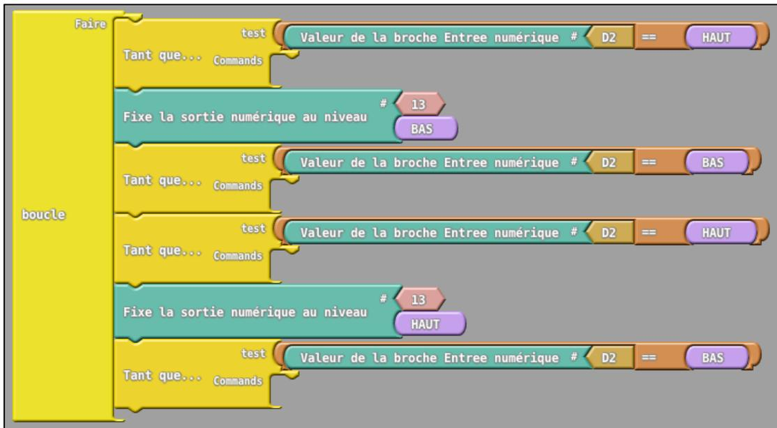
Figure 17 : Bloc Ardublock pour allumer et éteindre une led avec un bouton
