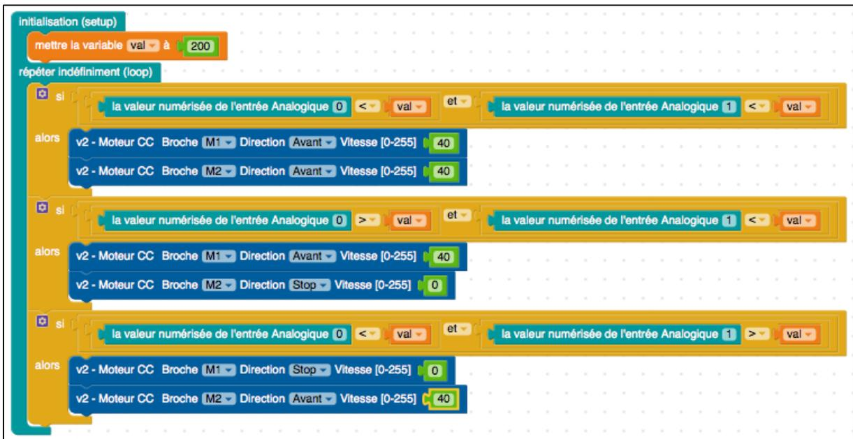
Figure 25: Bloc Blockly@rduino pour réaliser le suivi de ligne de notre robot
