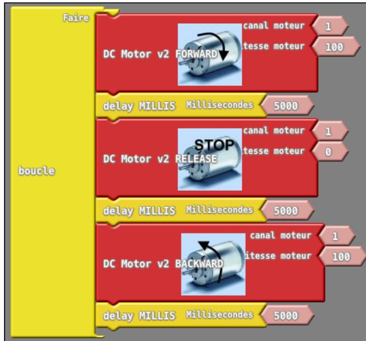
Figure 18 : Bloc ArduBlock pour faire fonctionner un moteur à courant continu
